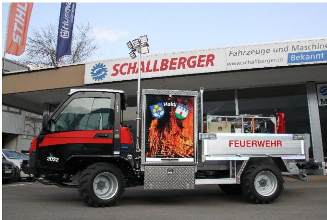
Fahrzeug mit Lichtmast und Aufbaukasten
