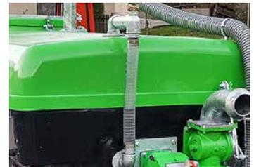
Füllstandsanzeige mit Schlauch, Art.-Nr. PFV5054
