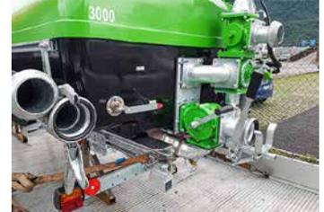
Schnellkuppler für Saugschlauch, Perrot NW 108, Art.-Nr. PFV5007
