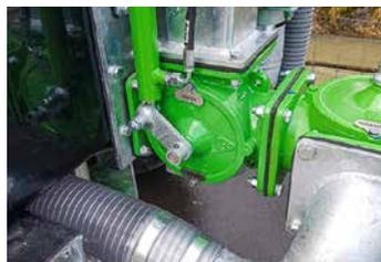
Talfahrt-Ausbringung hydraulisch bedient, Art.-Nr. PFV5029
