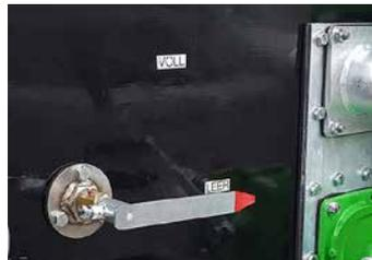
Füllstandsanzeige mechanisch mit Schwimmer, Art.-Nr. PFV5027
